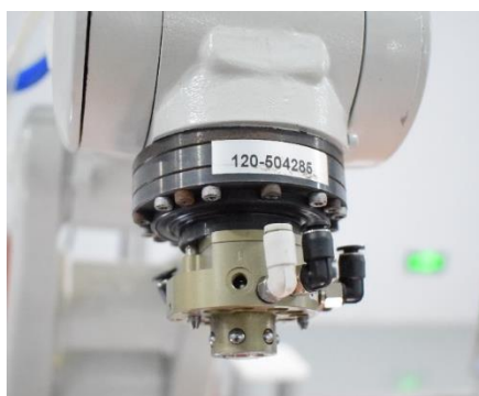
图 1-2 工具快换装置主端口安装完成示意图
